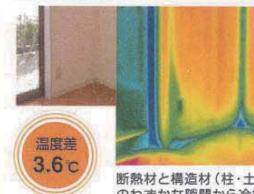
断熱材と構造材(柱・土台)
